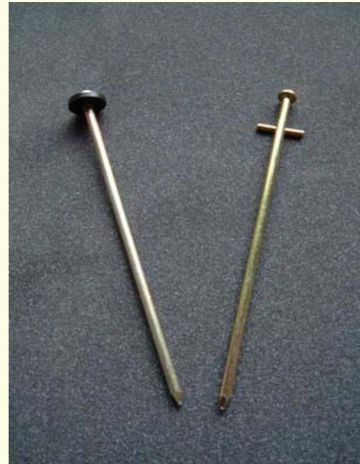
giardino, sono facilmente collocabili all'interno del terreno e servono a tracciare il percorso che dovrà essere seguito per effettuare lo scavo all'interno del quale collocare il tubo. Senza l'uso dei picchetti diventerebbe difficile trovare il punto esatto per l'installazione dell'irrigatore. Si tratta sostanzialmente di uno
